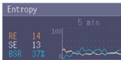
5. Auf dem Bildschirm kann der Burst-Unterdrückungsquotient (BSR) ausgewählt werden, um das Ausmaß der Innervationsstille im Roh-EEG anzuzeigen.
